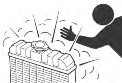
Varm damp kan sprøjte ud, når kølerdækslet åbnes
