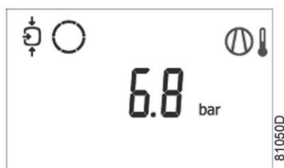
Hovedmenu med indikation af shut-down, afgangstemperatur
