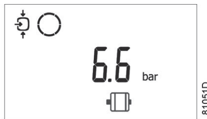
Hovedmenu med indikation af generelt stop, motoroverbelastning
