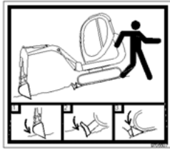
Fig. 23: Korrekt standsning af køretøjet
