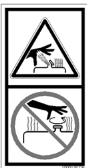
Fig. 18: Hydraulikolietanken står under tryk
